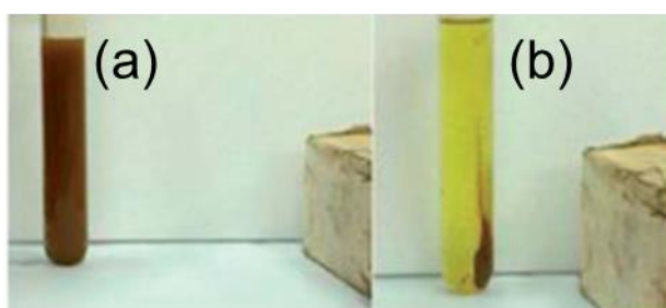
Figura 7. Separação das nanopartículas magnéticas de cobre do meio reacional: (a) antes e (b) depois da aproximação de um ímã (adaptado da referência 45b).
