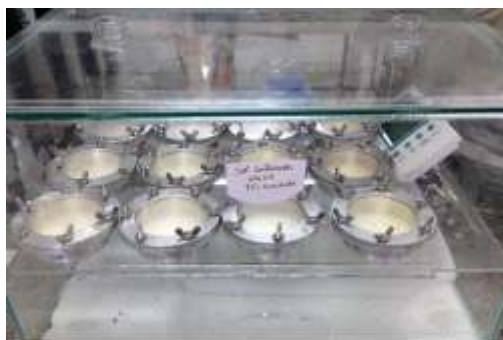
Figura 12 - Células de permeação armazenadas em cuba de vidro para análise de PVA.
