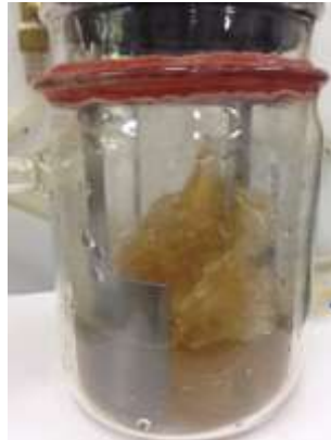
Figura 8 - Célula ôhmica contendo o resíduo de gelatina e água para formação da solução filmogênica.
