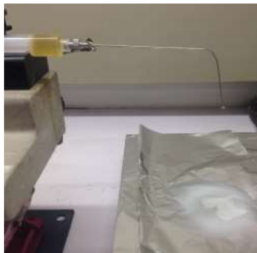
Figura 10 - Agulha conectada à seringa e coletor de alumínio durante electrospinning de solução de gelatina.
