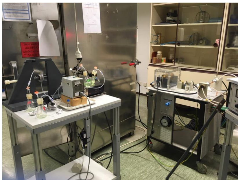
Figura 19. Aparato experimental utilizado nos experimentos de extração com PEF.
