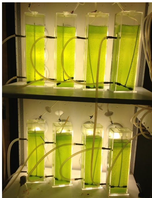
Figura 11. Fotobiorreatores durante um cultivo de microalgas.
