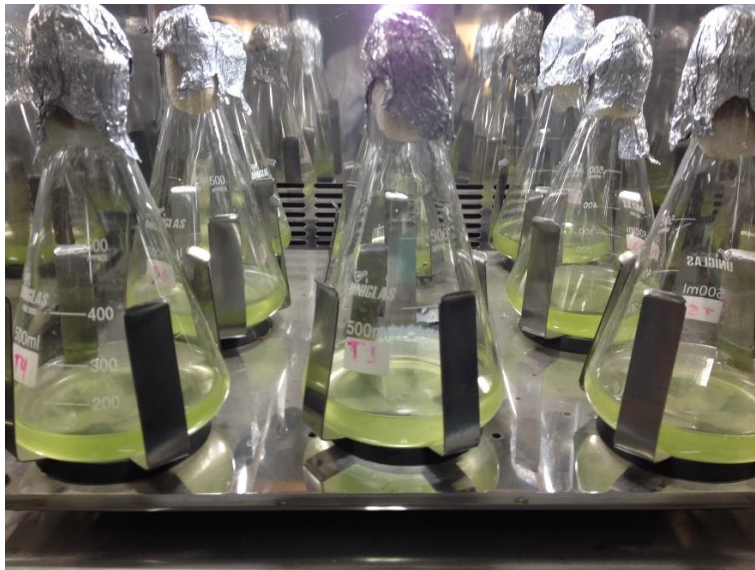
Figura 10. Pré-inóculos realizados previamente ao cultivo nos fotobiorreatores.
