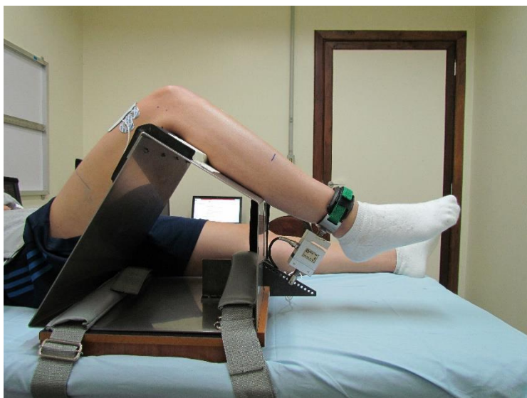
Figura 1. Fixação da estrutura. Estrutura em aço inoxidável à maca e a célula de carga à extremidade de um dos membros inferiores.
