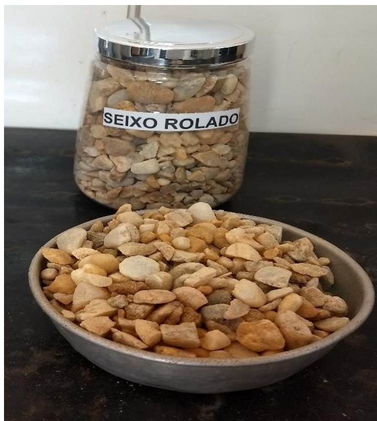
Figura 5.10. Agregado graúdo utilizado na fabricação do concreto.
