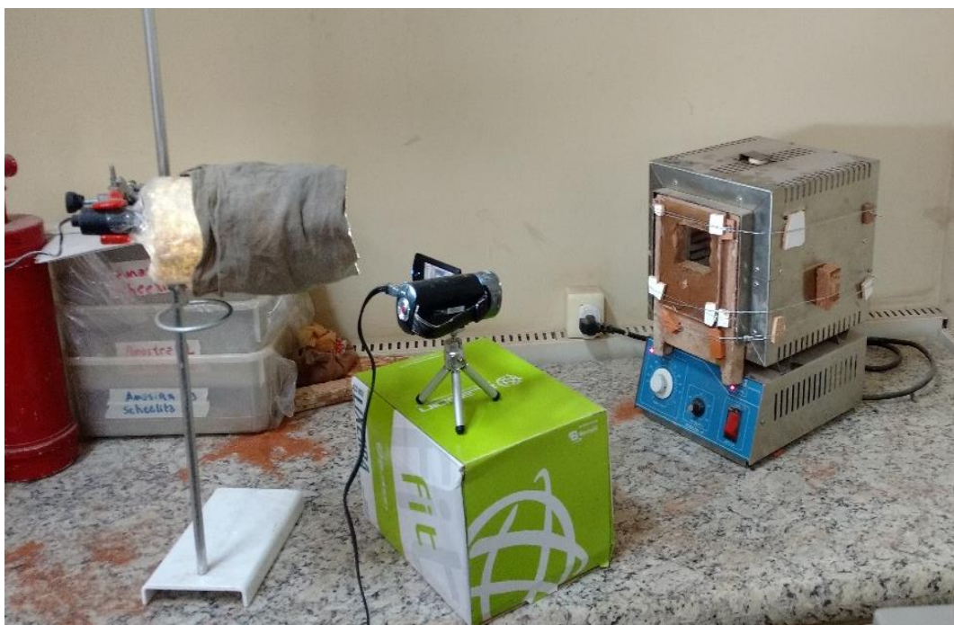
Figura 6.2. Filmagem da amostra em aquecimento no pré-teste.
