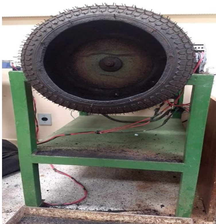
Figura 5.11. Equipamento usado para pelotizar as matérias-primas.
