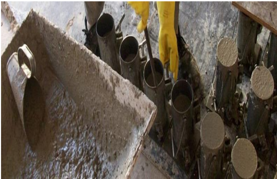
Figura 5.14. Moldagem dos corpos-de-prova de concreto.
