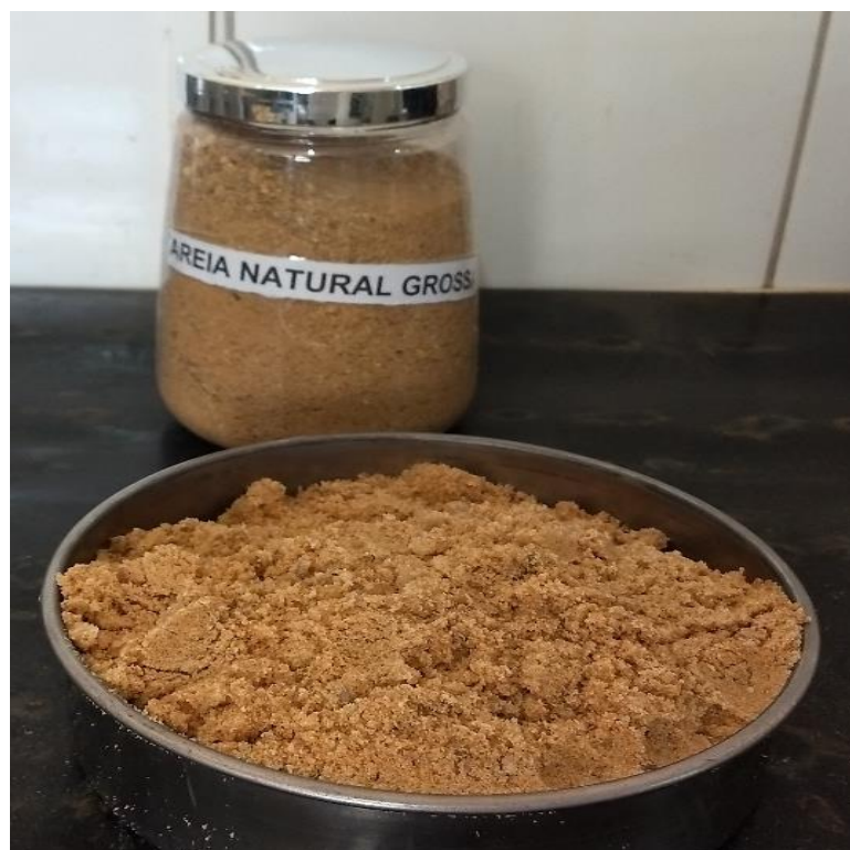
Figura 5.9. Agregado miúdo utilizado para a fabricação do concreto.
