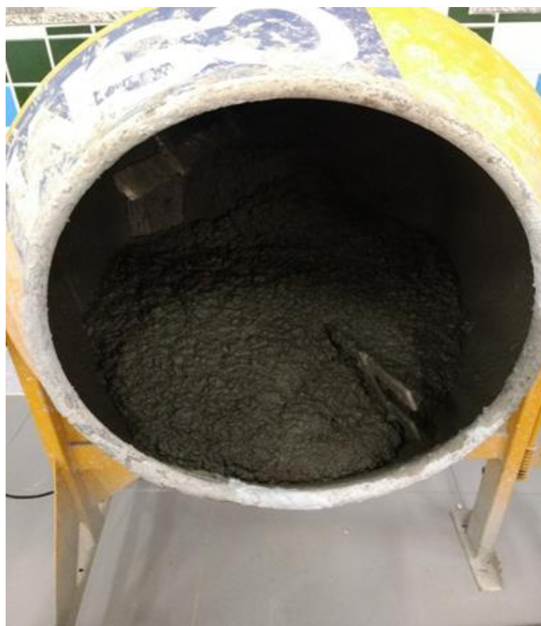
Figura 5.13. Betoneira elétrica de 120 litros.
