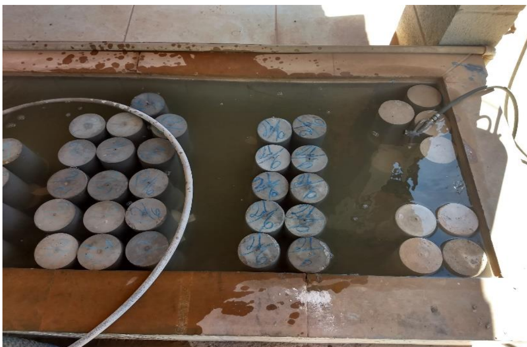
Figura 5.15. Cura das amostras de concreto em tanque de água saturada.
