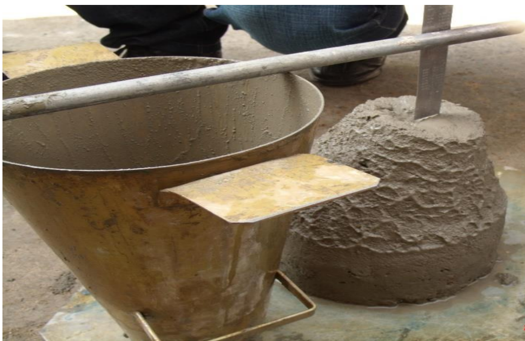
Figura 5.16. Ensaio de Slump .
