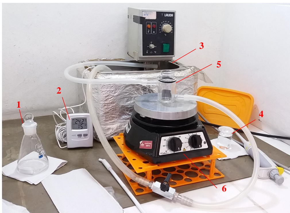
Figura 3.1 – Aparato experimental utilizado para determinação da curva de ponto de nuvem.
