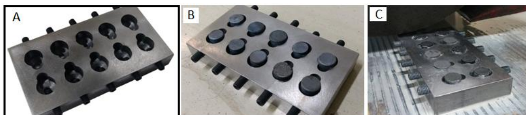
Figura 26 - Ferramenta para fixação das amostras na mesa magnética da retificadora
