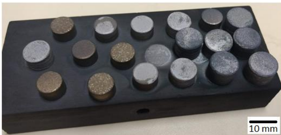
Figura 23 - Base de grafite para proteção das amostras
