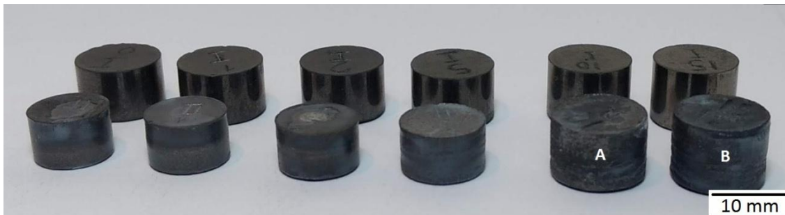
Figura 29 - Comparação entre as amostras a verde (no fundo) e as amostras sinterizadas em 1360 °C (primeiro plano da imagem) - Amostras A e B descartadas
