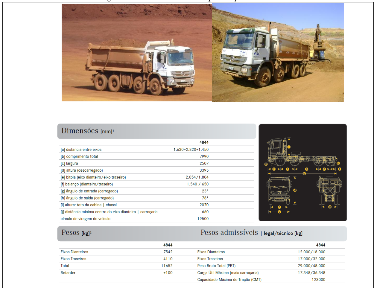
Figura 26. Caminhões Astros e especificações técnicas
