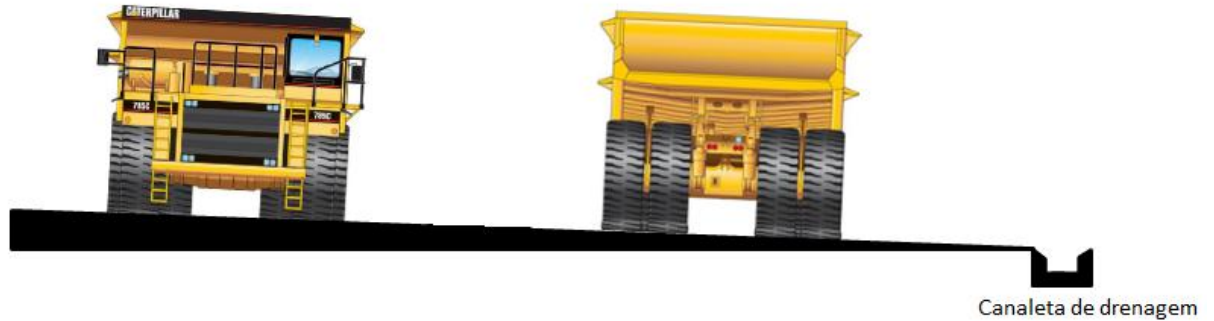
Figura 11. Inclinação transversal com caimento lateral único
