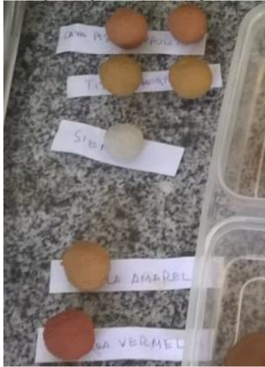
Figura 43 -Pelotas de fração de argila de cada material para teste de resistência a seco
