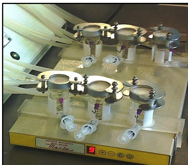
Figura 7. Montagem da célula de Franz para estudo de permeação/retenção cutânea
