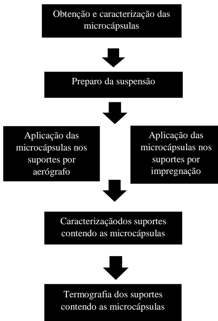
Através da rota sol-gel foram obtidos dois tipos de microcápsulas, e suas posteriores caracterizações foram feitas via estéreo microscópio, MEV, FIB, EDS e BET. A aplicação foi feita utilizando os métodos de impregnação e por aerógrafo, e os suportes contendo as microcápsulas aplicadas foram caracterizados via MEV. Para análise da aplicação final como barreira térmica utilizou-se a técnica de termografia.
