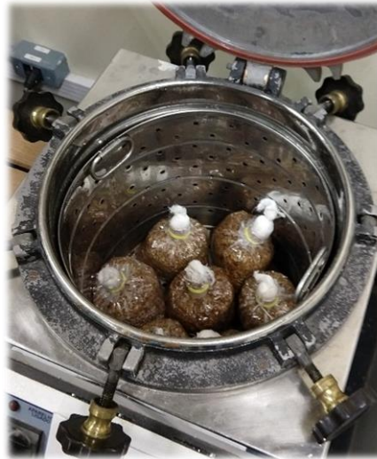
Figure 11 – Batelada de sacos sendo autoclavada.
