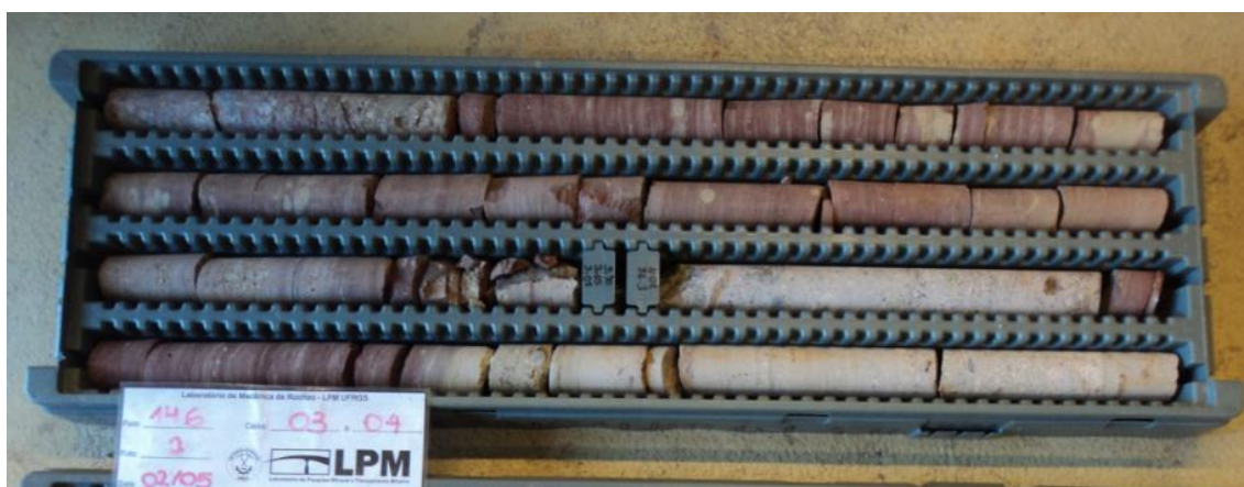
Figura 2: Caixa com testemunhos provenientes de sondagem rotativa.
