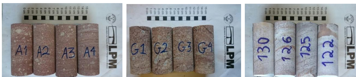
Figura 32: Amostras de arenito, conglomerado e ritmito, respectivamente
