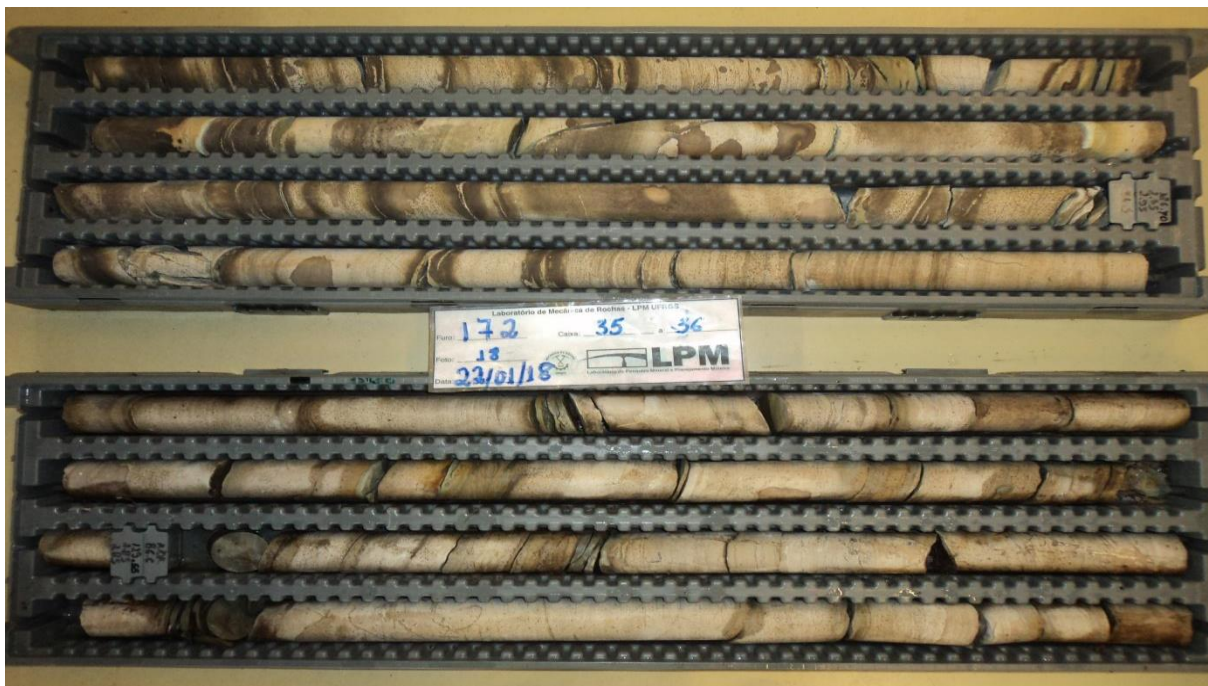
Figura 27: Caixa de testemunhos com registro do trecho e recuperação obtidos.
