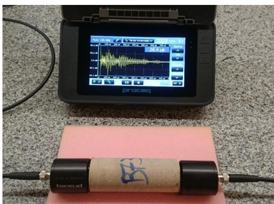
Figura 30: Equipamento de medição de velocidade ultrassônica utilizado nos ensaios.
