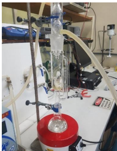
Figura 12: Aparato experimental montado para extração da farinha.
