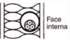
Face interna | Cabo multipolar em eletroduto de seção circular embutido em parede termicamente isolante <sup>2)</sup>                                                    | A2                                 |
