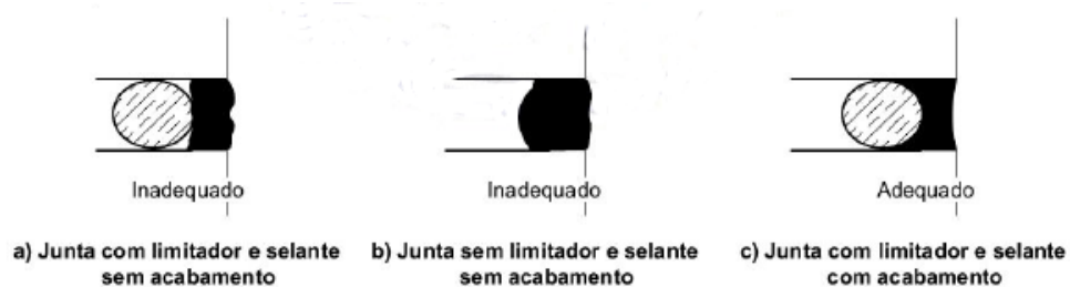
Figura 22 – Esquema de aplicação do selante
