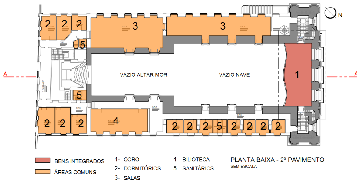
Figura 15 - Planta baixa do segundo pavimento com as áreas as áreas críticas e comuns
