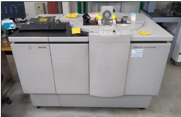
Figura 21. Espectrômetro de emissão de Raio-X Philips modelo PW-2600. Fonte: Cortesia da Gerdau Charqueadas (2018).
