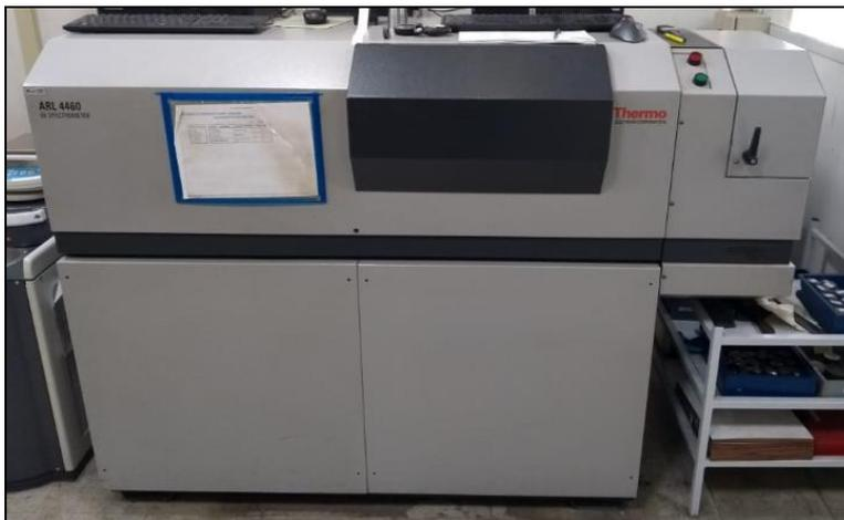
Figura 20. Espectrômetro de emissão ótica Thermo modelo ARL4460. Fonte: Cortesia da Gerdau Charqueadas (2018).
