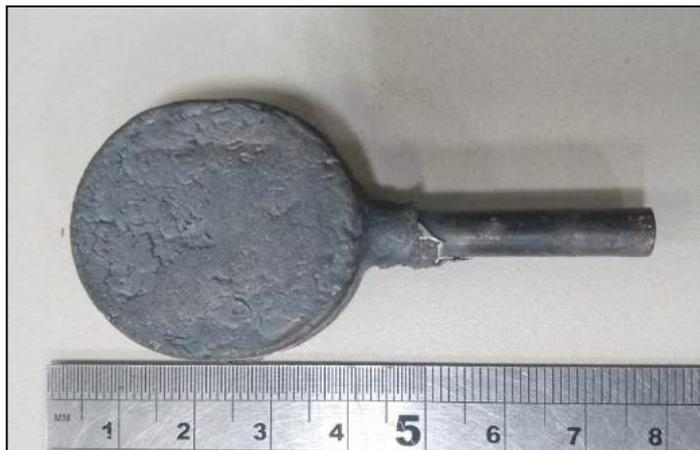
Figura 25. Amostra de aço retirada do FEA. Fonte: cortesia da Gerdau Charqueadas.
