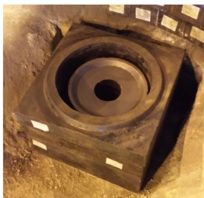
Figura 3.3. Sedes refratárias montadas na carcaça com o conjunto de luvas inserido em seu orifício.
