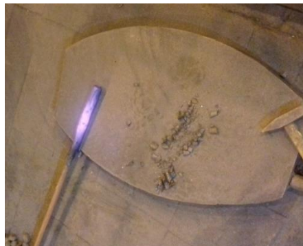
Figura 3.6. Escória aderida em vara tubular durante amostragem no forno-panela.
