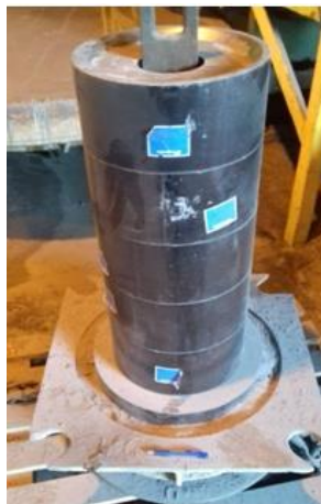
Figura 3.2. Luvras refratárias do canal EBT montadas em gabarito para inserção na carcaça.
