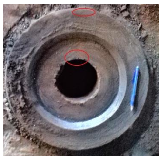
Figura 3.7. Representação das regiões de retirada de amostras para análise de composição química e fases presentes da luva externa do canal EBT.
