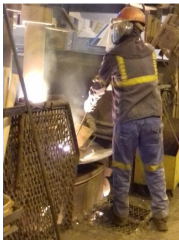
Figura 3.5. Retirada de amostra de aço no forno-panela.
