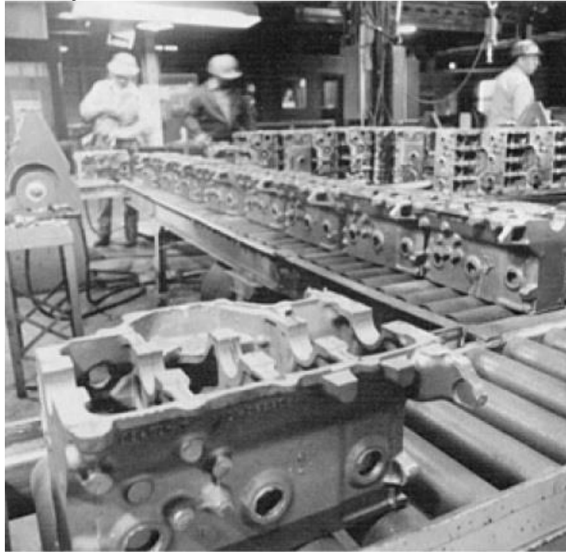
Figura 2. Produção de milhões de blocos de motor automotivo em ferro fundido.
