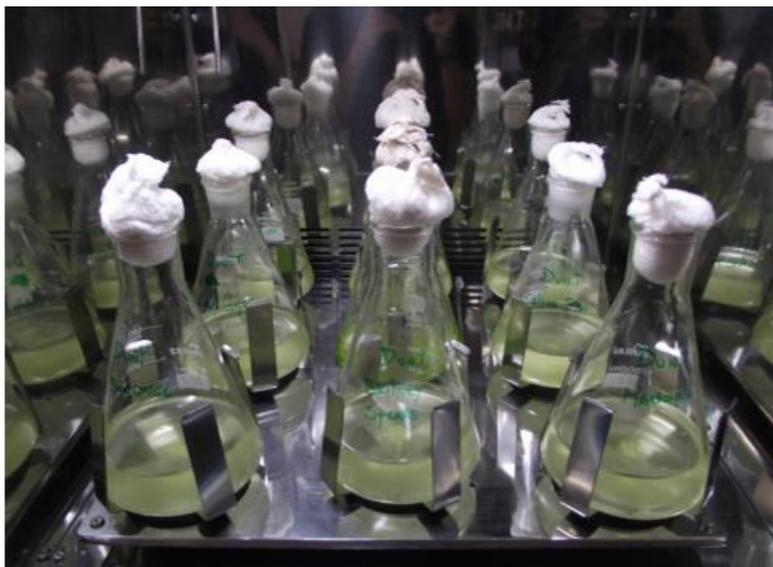
**Figura 9.** Estufa rotatória com os pré-inóculos das microalgas.
