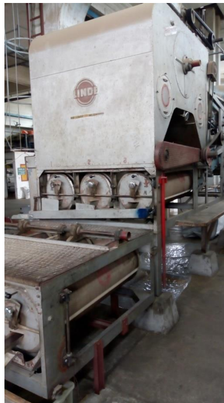
Figura 7 – Máquina de ar e peneiras (MAP) na Unidade de Beneficiamento de Sementes (UBS). INIA/La Estanzuela. Safra 2018/2019.
