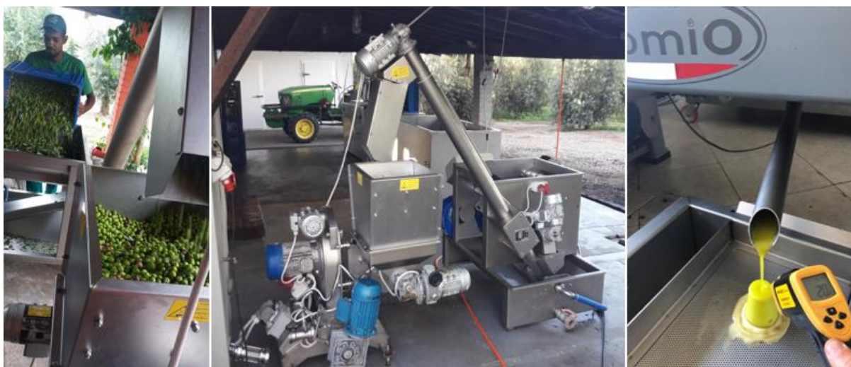
Figura 3 – Extração de azeite: limpeza dos frutos e moagem e extração de azeite com detalhe na temperatura final do produto.
