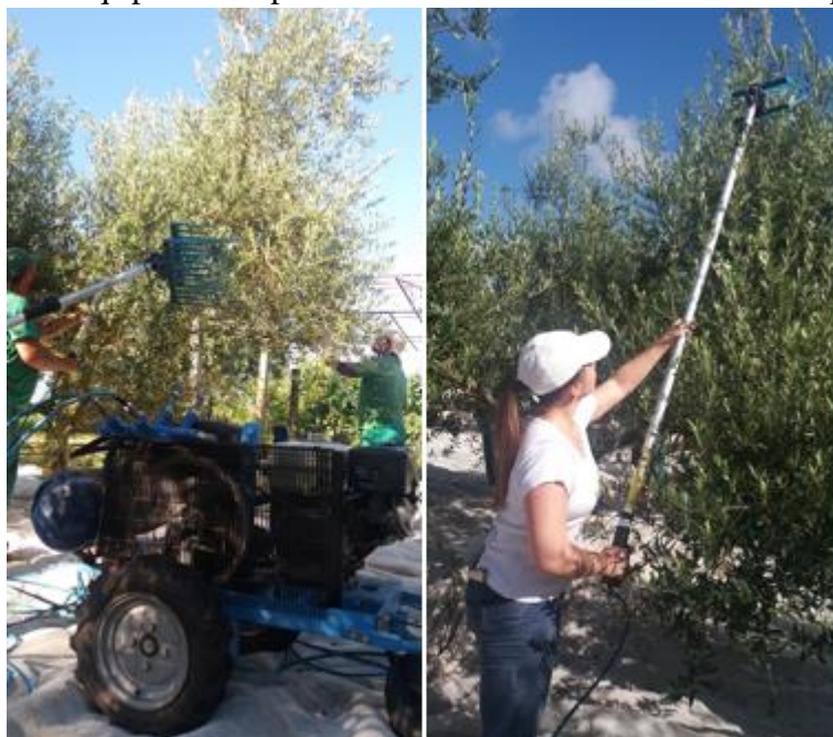
Figura 2: Equipamento para colheita semimecanizada: motor e pentes
