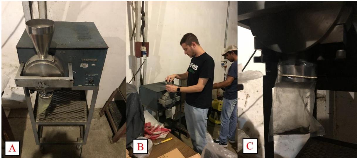
Figura 3. Etapas para moagem de forragem de campo nativo. A) Moinho de moagem. B) Pressão com pilão. C) Saco plástico acoplado. INIA, Tacuarembó/Uruguai, 2019.
