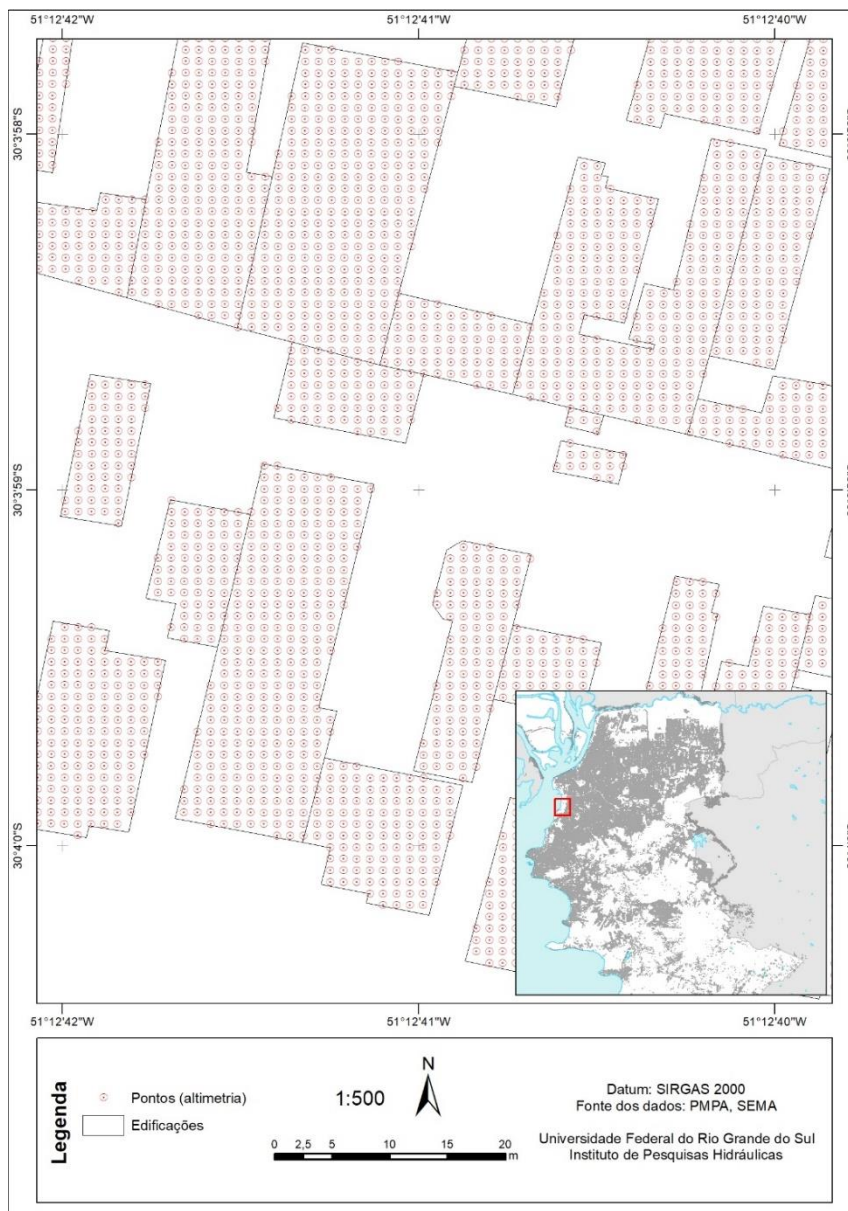
Figura 6 – Exemplo de pontos dentro de edificações.
