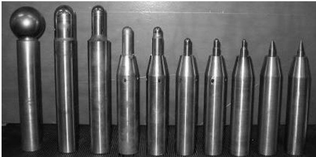
Figura 20: Ferramentas com extremidade esférica sólida de conformação Fonte: VIHTONEN; TUOMI, 2007
