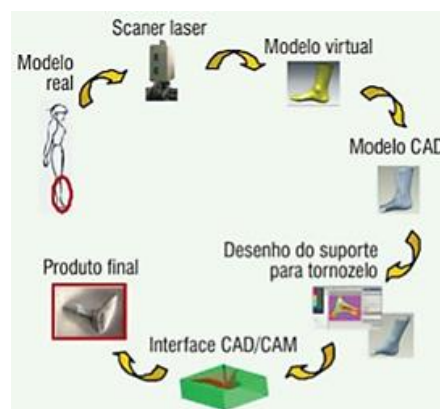
Figura 6: Ciclo de Aplicação da Estampagem Incremental Fonte: AMBROGIO, 2005 apud CASTELAN, 2010
