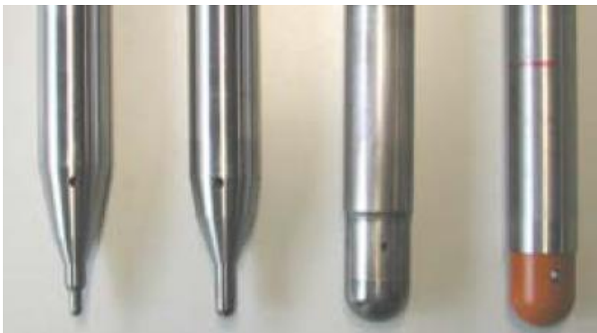
Figura 22: Ferramentas de conformação de ponta esférica sólida com 6, 10 e 30mm de diâmetro e com ponta de plástico (direita)
