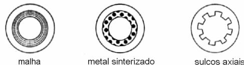
Figura 3.3 – Estruturas capilares usuais para dutos de calor de seção circular (Fonte: MILLS, 1995)
