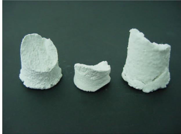
**Figura 8 - Corpo poroso – formado após calcinação do GEL a 800°C.**
