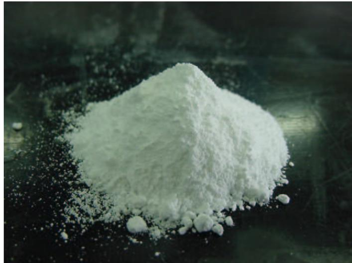
Figura 15 - Pó de alumina obtido através do método sol-gel.
