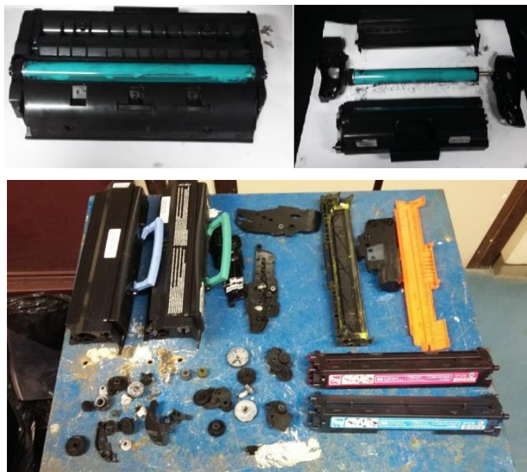
Figura 2 - Desmontelamento manual dos cartuchos toneres.
