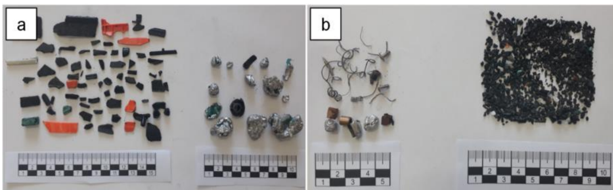
Figura 26 - Materiais poliméricos e metálicos moídos em granulometria variada, (a) moinho de martelo; (b) moinho de facas.
