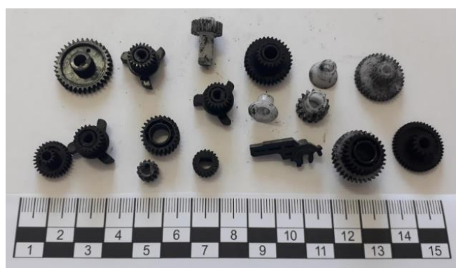
Figura 3 - Frações poliméricas de menor volume não analisadas dos cartuchos toneres.
