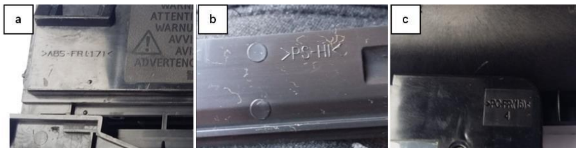
Figura 12 - Identificação dos polímeros na estrutura do toner produzida pelo fabricante.
