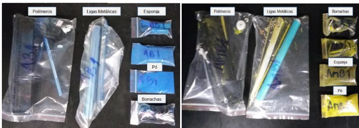
Figura 11 - Exemplos de Borrachas e esponjas contaminadas por pó de toner.
