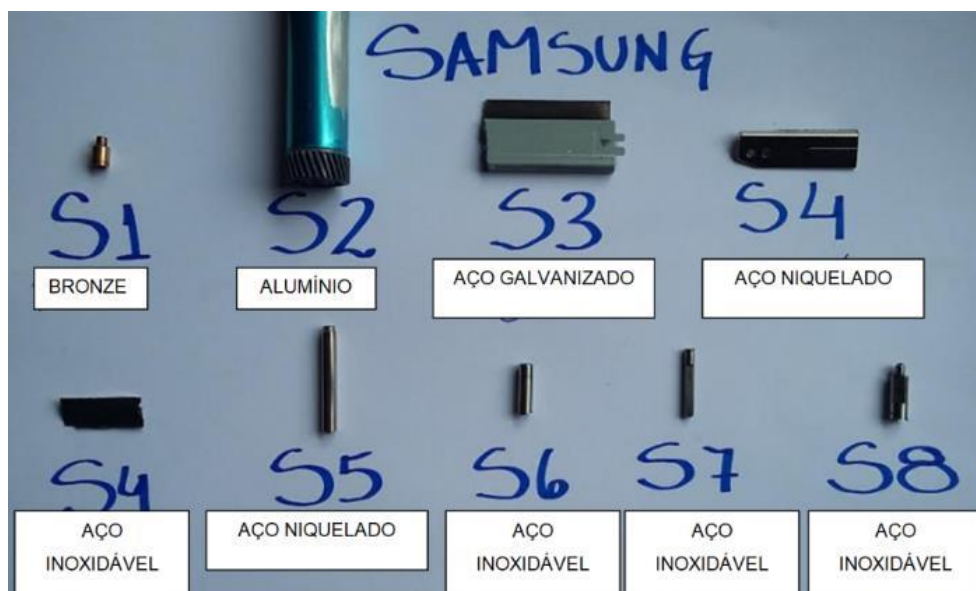
Figura 17 – Materiais metálicos identificados por EDFRX nos cartuchos da marca Samsung.
