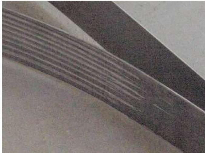
Figura 5.6 Danificação na chapa ensaiada.
