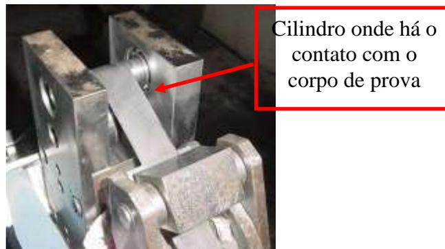
Figura 4.4 Chapa de aço sendo ensaiada. Material aço ABNT 1004.
