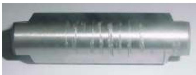
Figura 5.5 Danificação do eixo fixo da máquina.
