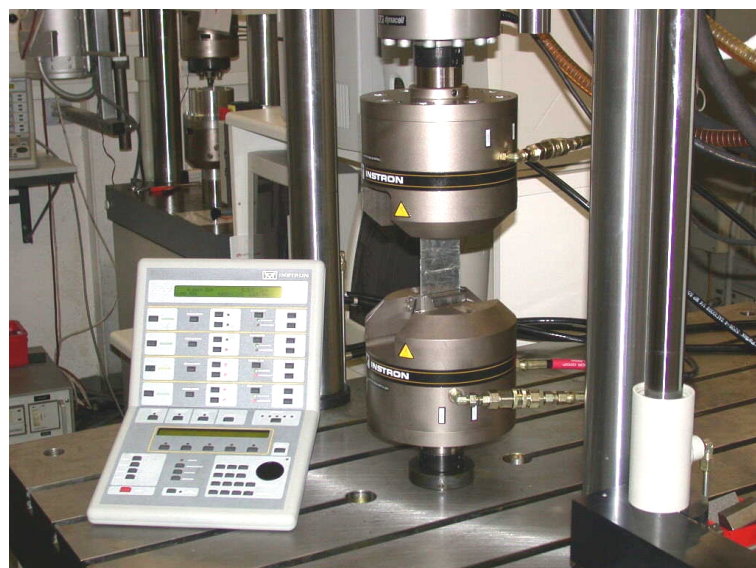
Figura 5 – Máquina de ensaios de fadiga com corpo de prova montado.
