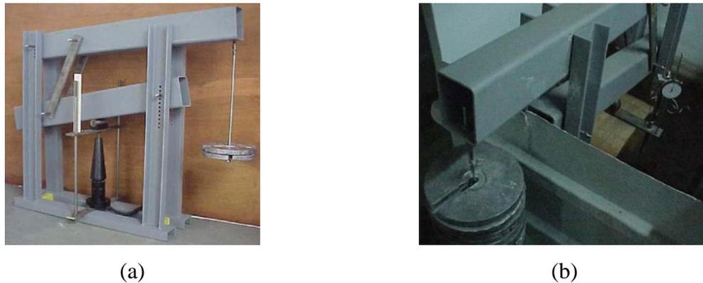
Figura 3.11 – Equipamento de teste de fluência: (a) durante a calibração de carga e (b) teste de fluência em tanque com água.
