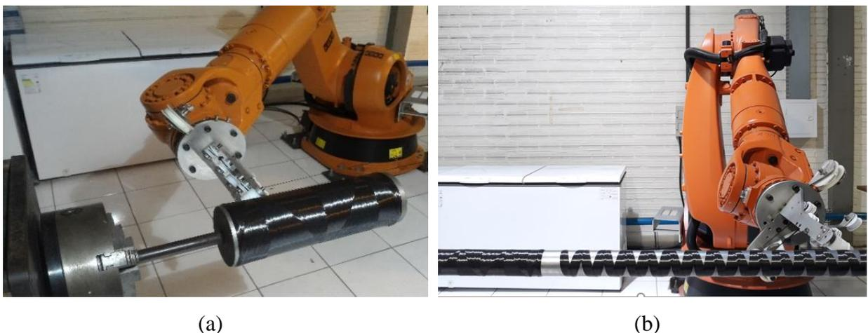
Figura 4.4 – Fabricação de tubos compósitos: (a) diâmetros de 136 mm e (b) 50,8 mm.
