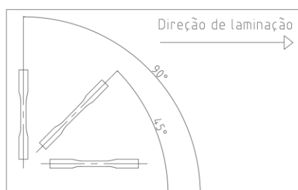
Figura 3.7 – Configuração para obtenção dos corpos de prova para ensaio de anisotropia de uma chapa.
