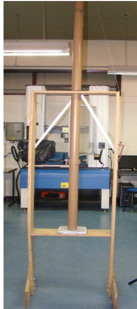
Figura 13 – Sistema para ensaio de impacto por queda de dardo utilizado no trabalho.
