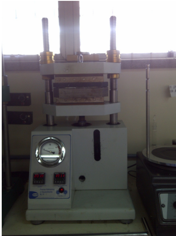
Figura 11 – Prensa Hidráulica utilizada para confecção dos painéis sanduiche.
