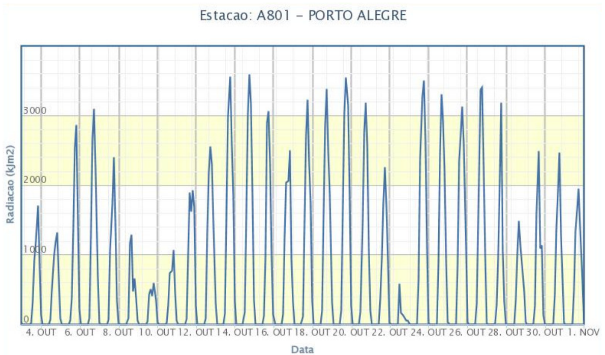
Figura 18 - Radiação ultravioleta durante o ensaio de envelhecimento natural. Fonte: Dados da rede do INMET.
