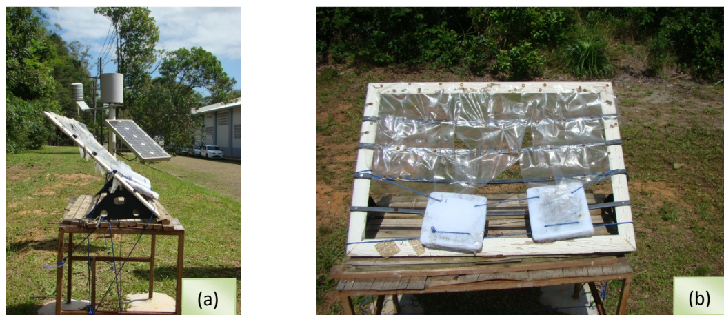
Figura 17 – Imagens do ensaio de envelhecimento natural. (a) mostrando a inclinação de 45° da mesa. (b) visão geral da mesa de apoio das placas.
