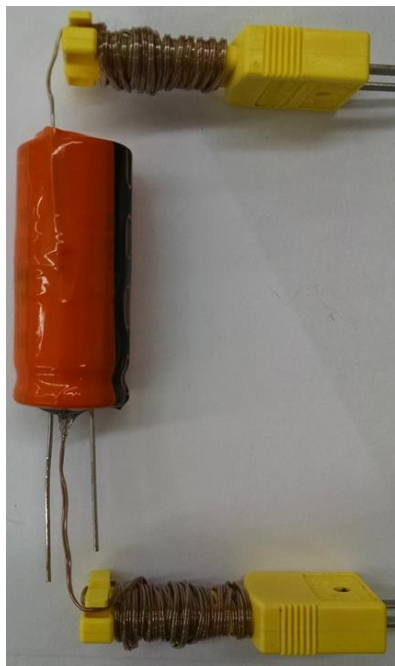
Figura 39: Medição de temperatura da caneca e do núcleo do capacitor
