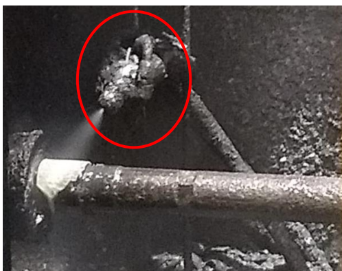
Figura 5.8 - Sistema de lubrificação por aerossol ( Spray ).
