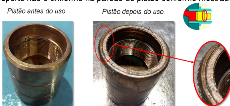
Figura 5.9 – Deformação no pistão pela distribuição não uniforme de cargas.
