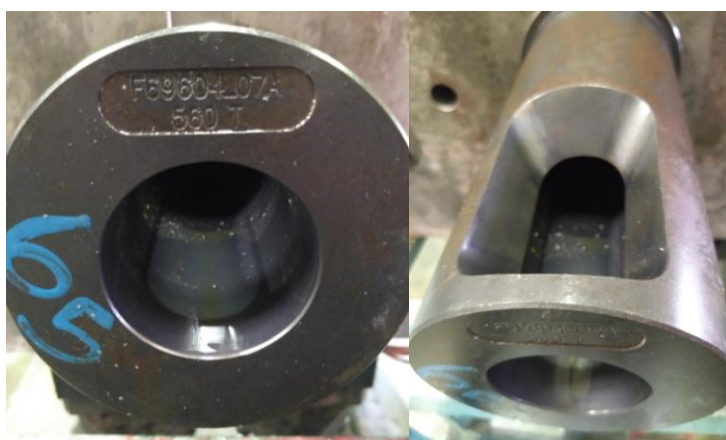
Figura A3 – Câmara de Injeção nova.
