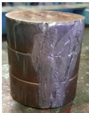
Figura 5.1 – Pistão de Cobre ao final da vida útil.
