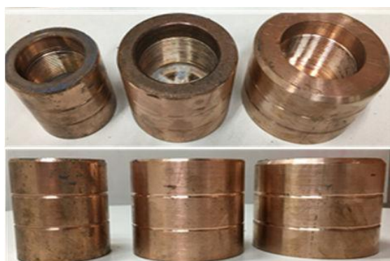
Figura 3.7 - Pistões de cobre para injeção de alumínio sob pressão.
