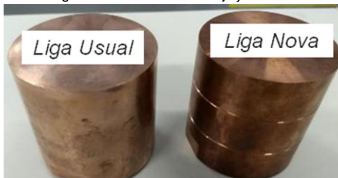
Figura A4 – Ligas de pistão utilizadas: CNCS (Usual) e CCNB (Proposta).
