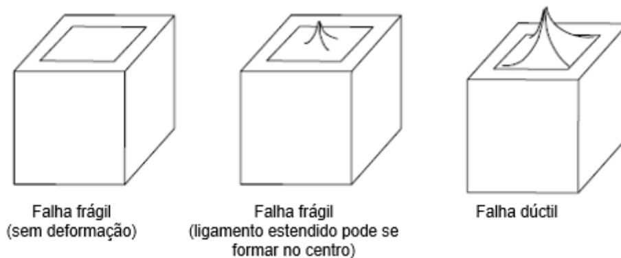
Figura 13 – Exemplos de superfícies de falha (adaptado de [68]).
