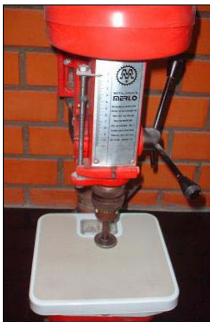
Figura 18 - Prensa utilizada na confecção de pastilhas
