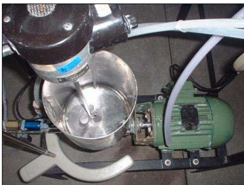
Figura 14 - Tanque com defletores, agitador e bomba de recirculação
