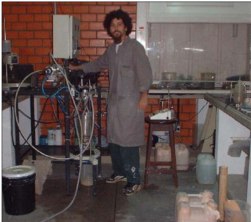
Figura 17 - Sistema Colorcell sendo utilizado para avaliar a cinética de alveijamento do caulim
