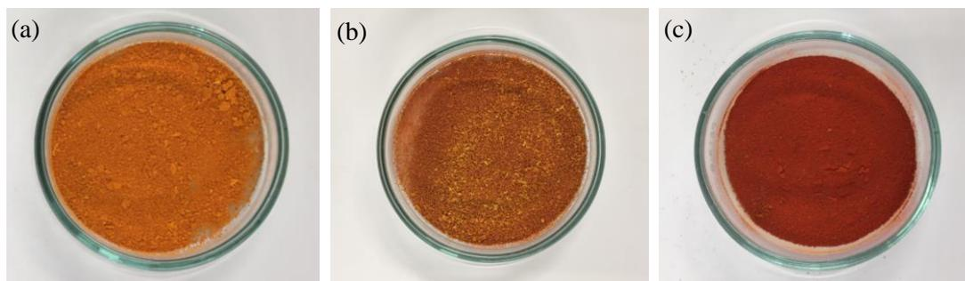
Figura 63: Polímero obtido por reação homogênea  $\text{PPARh}_1$  (a, b) e por reação heterogênea com o  $\text{PPAMSRh}_1$  (c).
