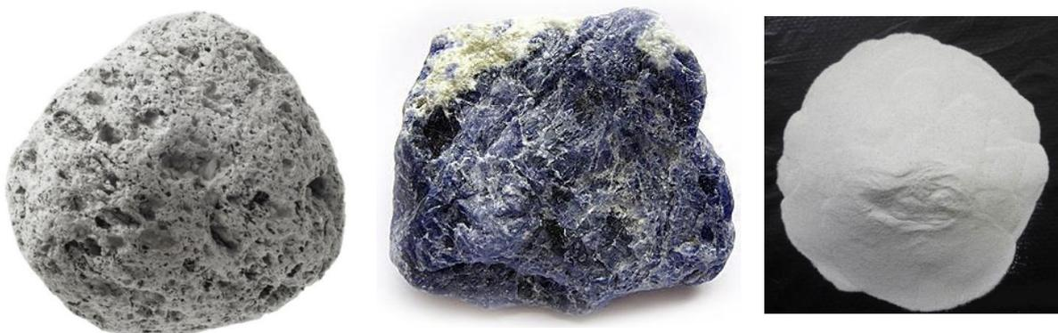
Figura 1: Peneiras moleculares naturais: Pedra-Pomes, à esquerda, e sodalita, no centro; à direita, uma amostra de zeólita ZSM-5 (24), uma peneira molecular sintética.
