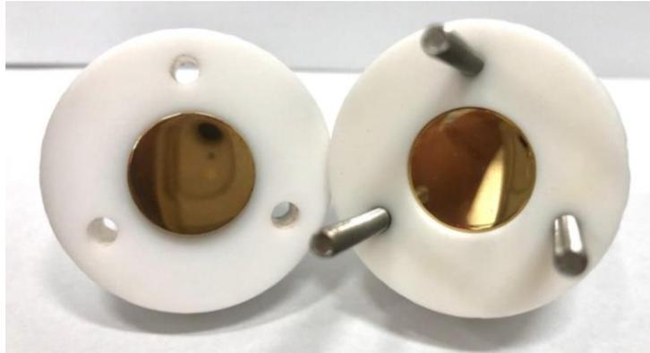
Figura 56: Célula de ouro utilizada nas medidas de condutividade do polímero.
