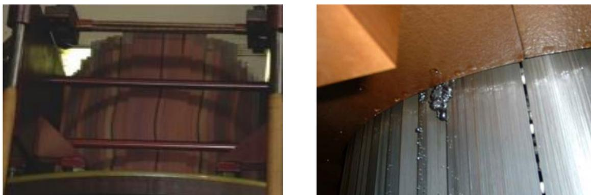
(a) Deformação do núcleo
