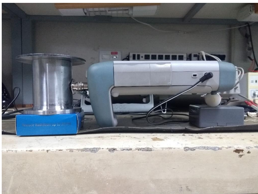
Figura 25 - Cavidade ressonante acoplada ao analisador de espectro. Vista lateral.
