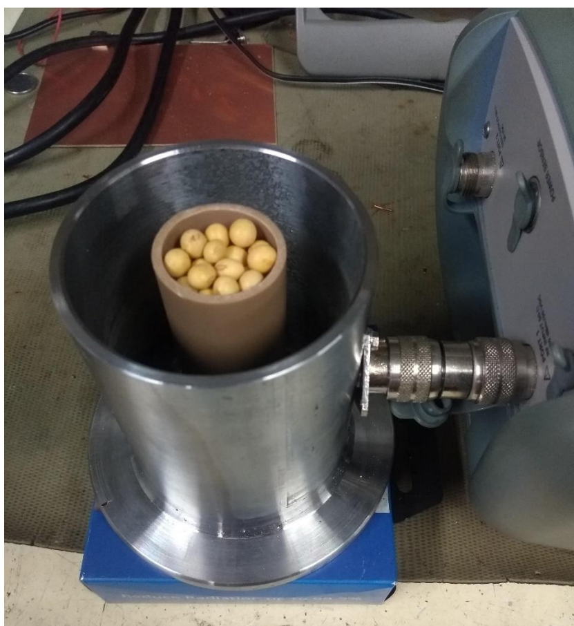
Figura 19 - Cavidade ressonante acoplada ao analisador de espectro e com a amostra inserida em seu interior.
