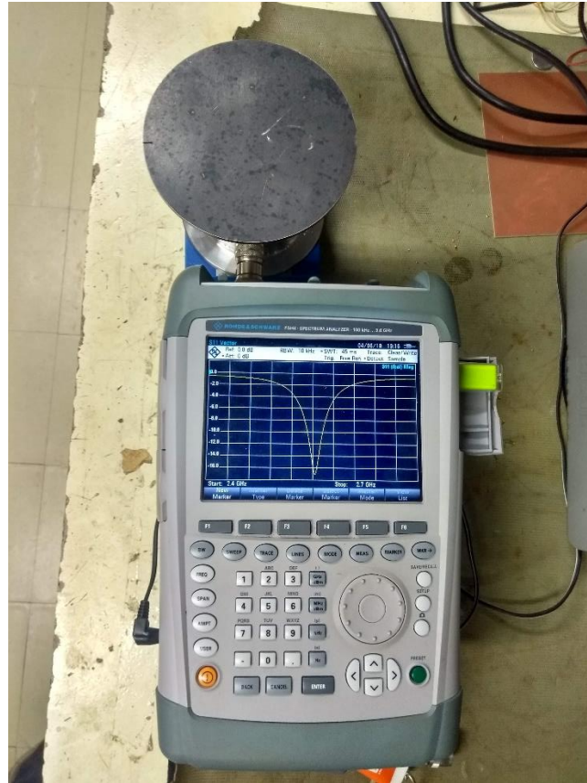
Figura 24 - Cavidade ressonante acoplada ao analisador de espectro. Vista superior.
