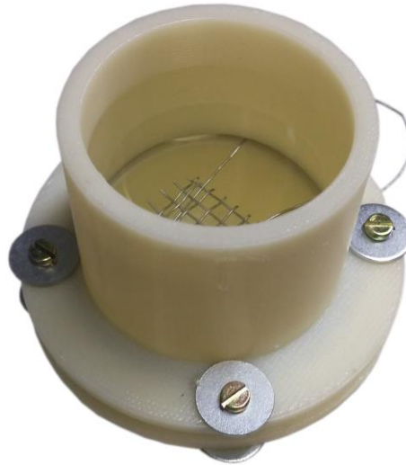
Figura 21 Célula montada para o monitoramento de pH superficial e OCP.
