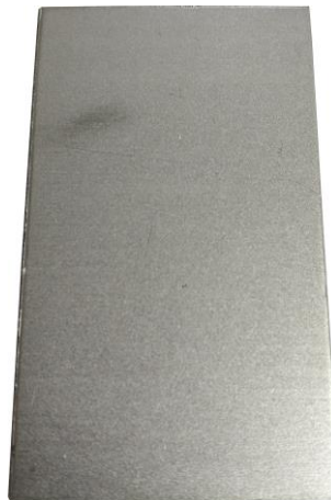
Figura 16 Foto da amostra de aço galvanizado cortada e desengraxada.
