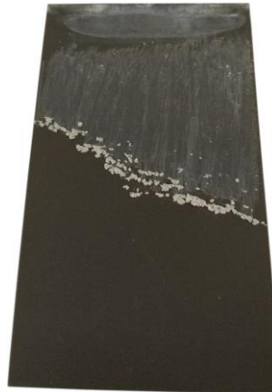
Figura 23 Amostra no processo de raspagem da camada de revestimento de conversão.
