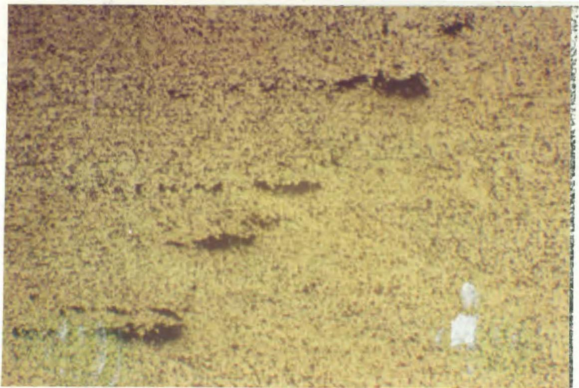
Figura 2.7. Aço carbono ASTM A 515 Gr.55 com 98.500 h de operação à 500°C mostrando grafitação segregada severa na linha Ac<sub>1</sub>. Nota-se também grafita alongada na direção de laminação da chapa<sup>(6)</sup>.
