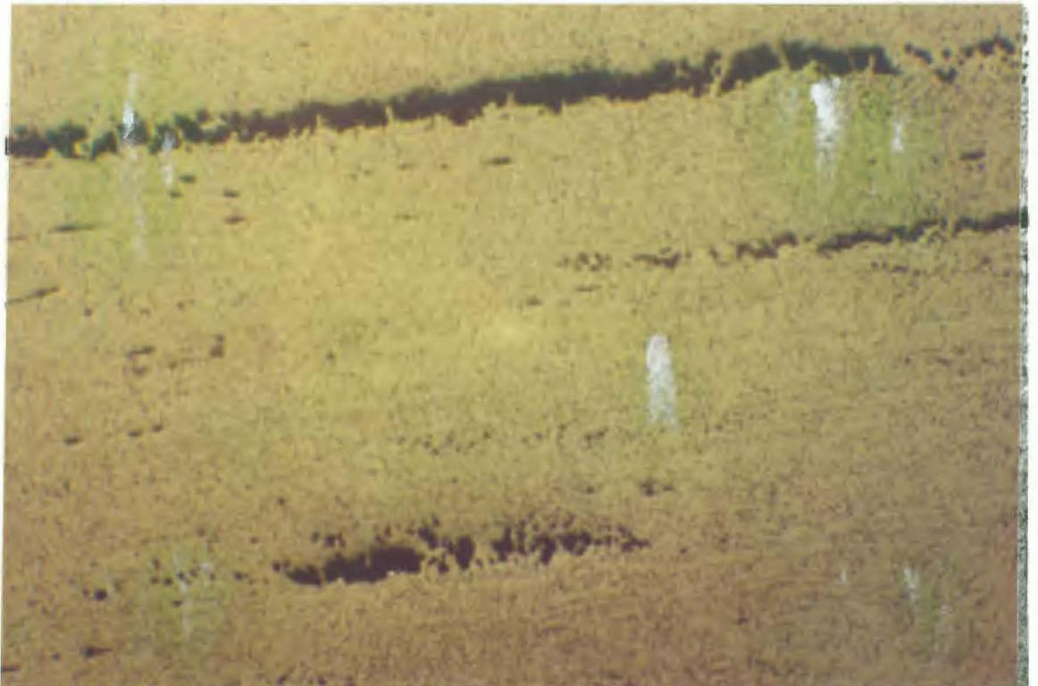
Figura 2.8. Aço carbono ASTM A515 Gr. 55 com 98.500 h de operação à 500°C mostrando grafitação alinhada na direção de laminação da chapa<sup>(6)</sup>.
