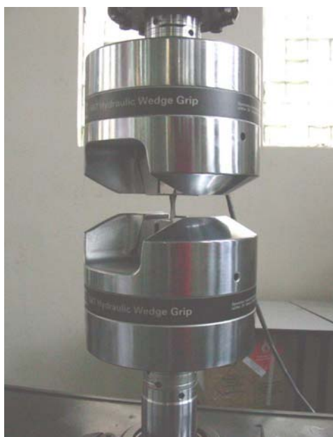
Figura 3.3 Ensaio realizado na máquina servo-hidráulica MTS utilizando corpos de prova de aço inoxidável austenítico ASTM F 745.
