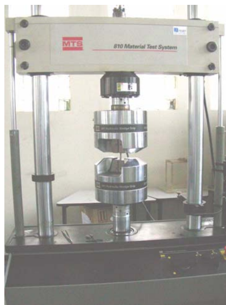
Figura 3.3 Ensaio realizado na máquina servo-hidráulica MTS utilizando corpos de prova de aço inoxidável austenítico ASTM F 745.
