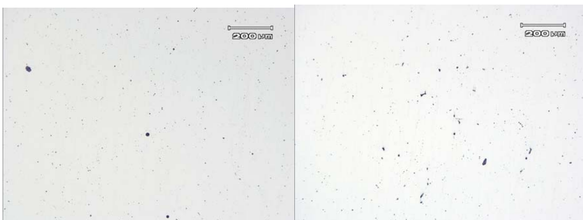
Figura 4.2 Micrografias à esquerda mostrando inclusões de óxidos do tipo D3 série fina e a direita mostrando microrechupes provenientes do processo de fundição.
