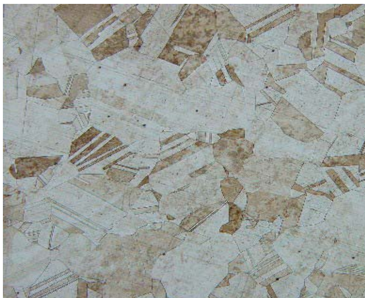
Figura 4.3 Microestrutura formada por grãos equiaxiais. Aumento: 500x
