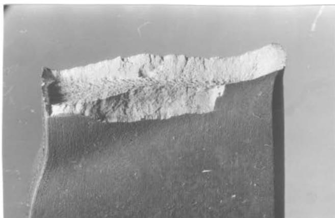
Figura 19 - Fratura do corpo de prova temperado e revenido.
