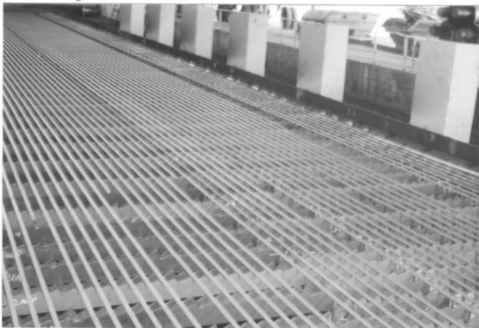
O processo de laminação desta bitola não apresentou problemas, obtendo-se barras sem defeitos superficiais e dentro das medidas especificadas. A figura 10 mostra a fotografia do material em estoque.
