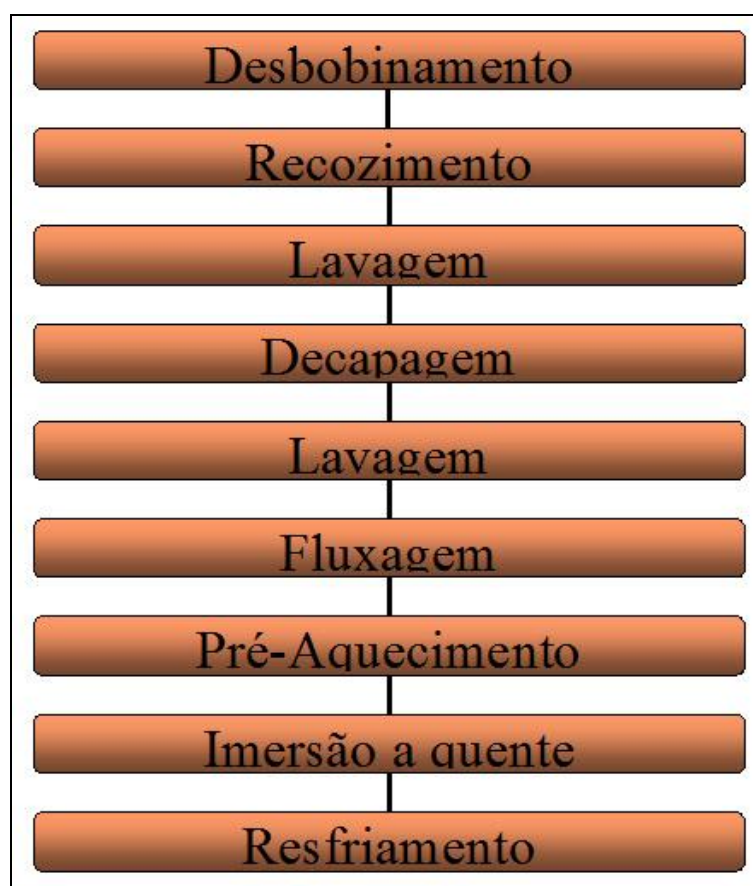
Figura 2.7 Fluxograma mostrando as etapas do processo de galvanização a fogo.
