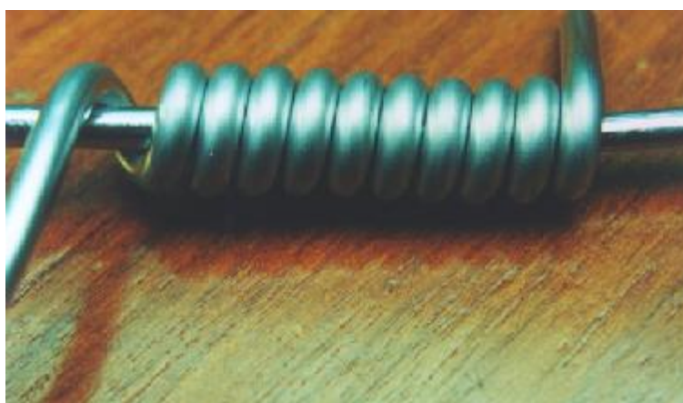
Figura 3.2 Imagem mostrando ensaio de pino para verificar a aderência da camada de zinco depositada sobre o arame de aço, pelo processo de galvanização a fogo.
