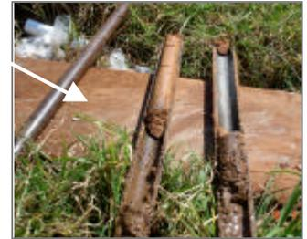
**Figura 17: Execução de sondagem com coleta de amostras**
