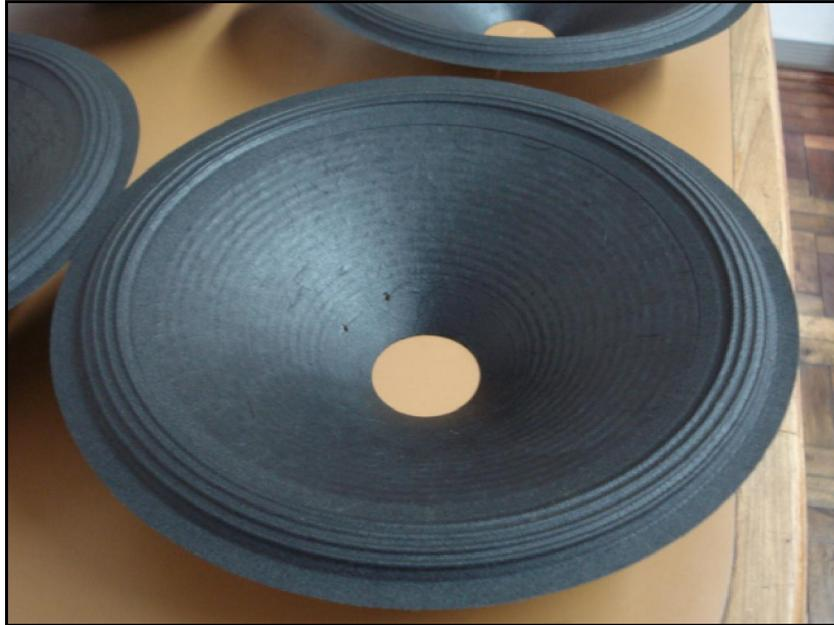
Figura 25 – Cone acabado como seu anel de suspensão.
