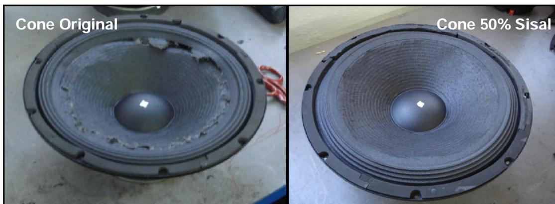
Figura 39 – Comparativo entre os alto-falantes após o Teste “Quebra-Cone”.
