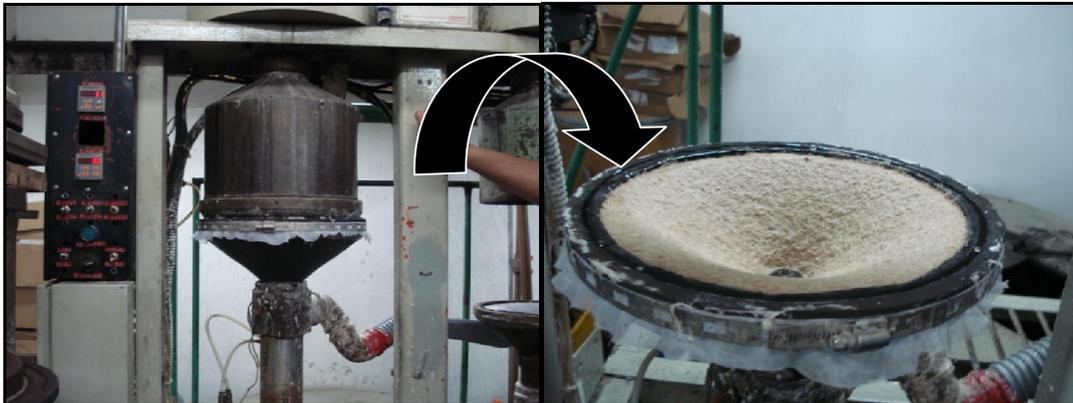
Figura 20 – Cone recebendo uma pré-forma.
