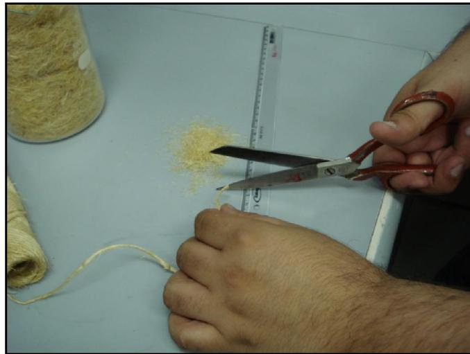
Figura 15 – Processo de corte das fibras.
