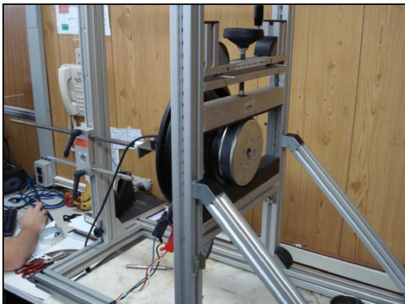
Figura 27 – Medição dos Parâmetros de Thille-Small.
