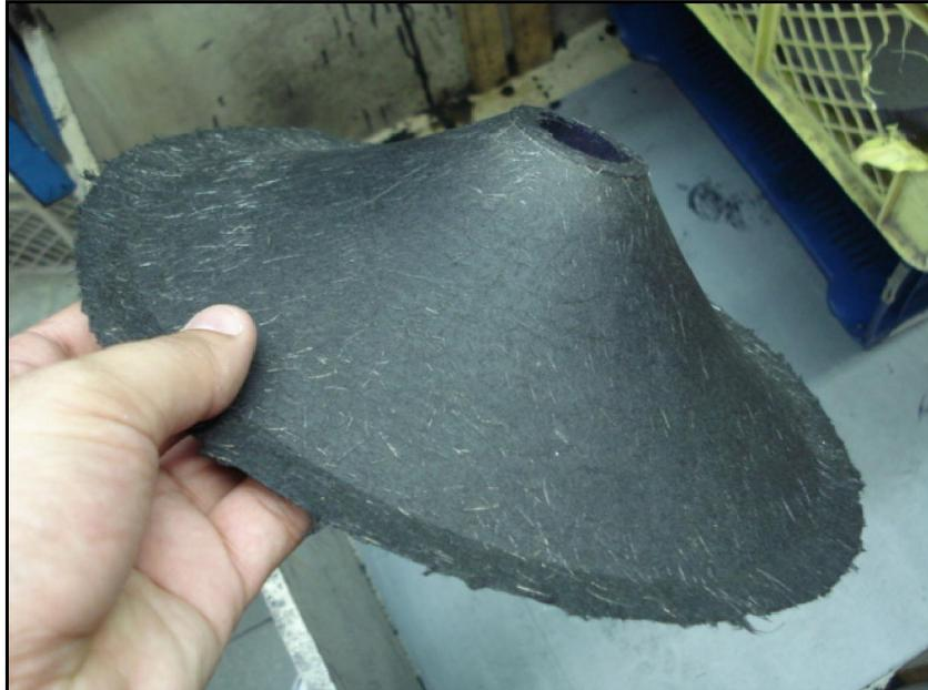
Figura 24 – Cone final, após ter sido impregnado, pintado e seco.
