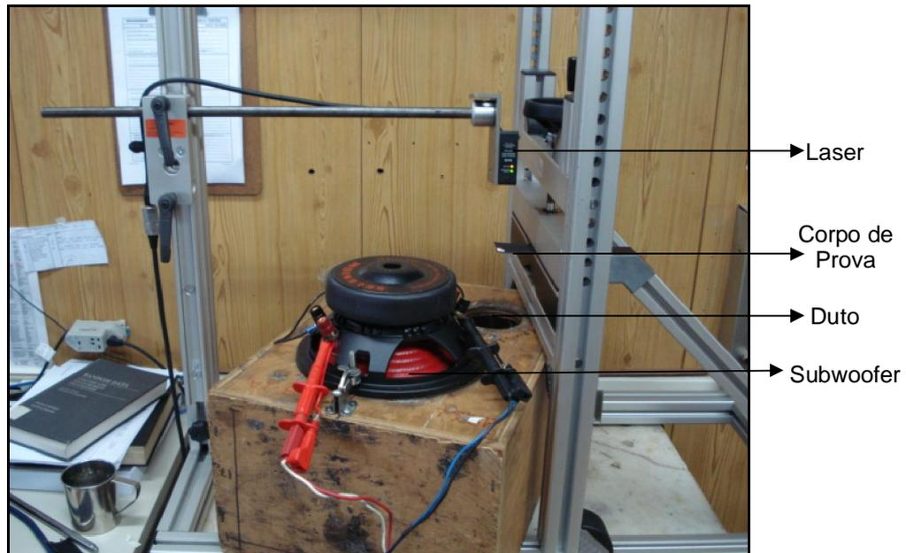
Figura 31 – Sistema de medição de frequência de ressonância.
