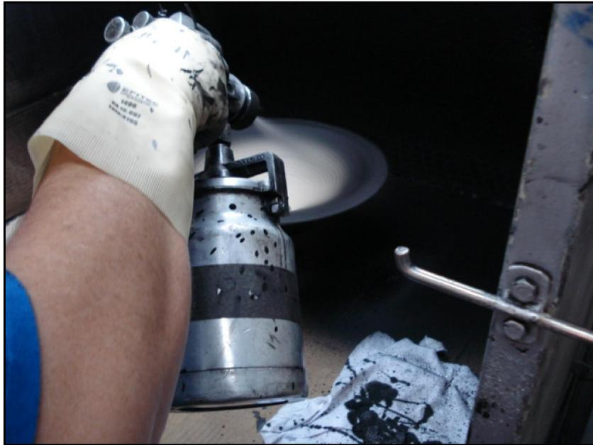
Figura 22 – Aplicação da resina + tinta.
