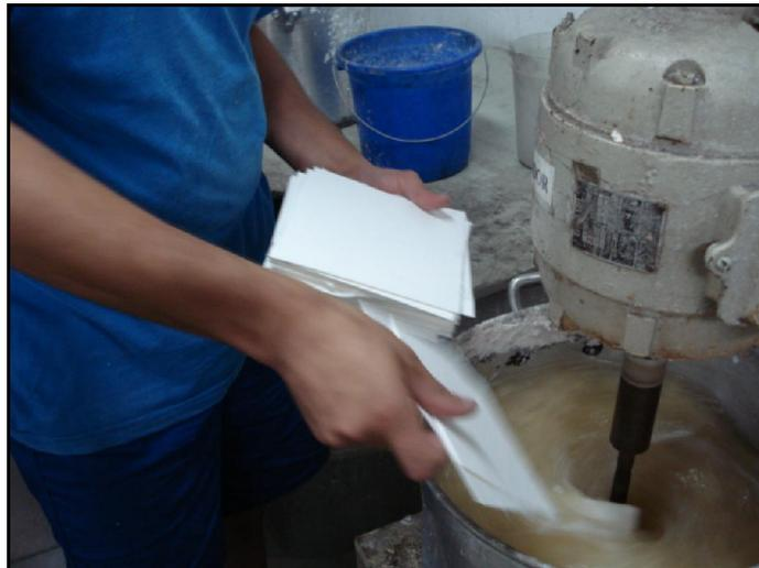
Figura 18 – Celulose sendo adicionada à solução.
