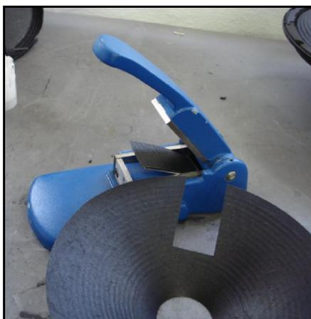
Figura 30 – Cortador gerador de corpos de prova.
