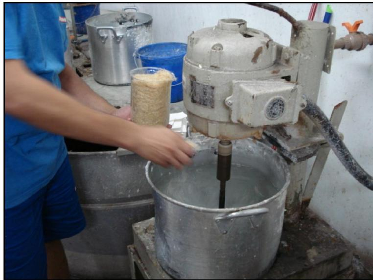
Figura 17 – Fibras de sisal sendo adicionados à solução.
