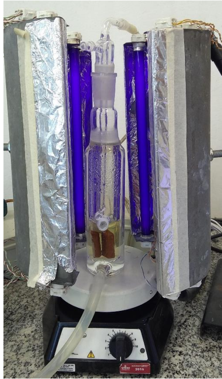
Figura 9 – Sistema montado para o ensaio de fotodegradação.
