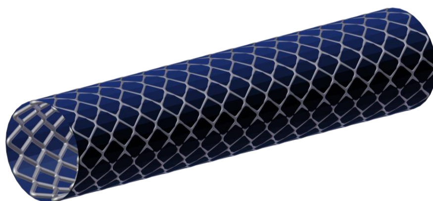
Figura 4.4 – Modelo equivalente (azul) representativo de todo o stent .
