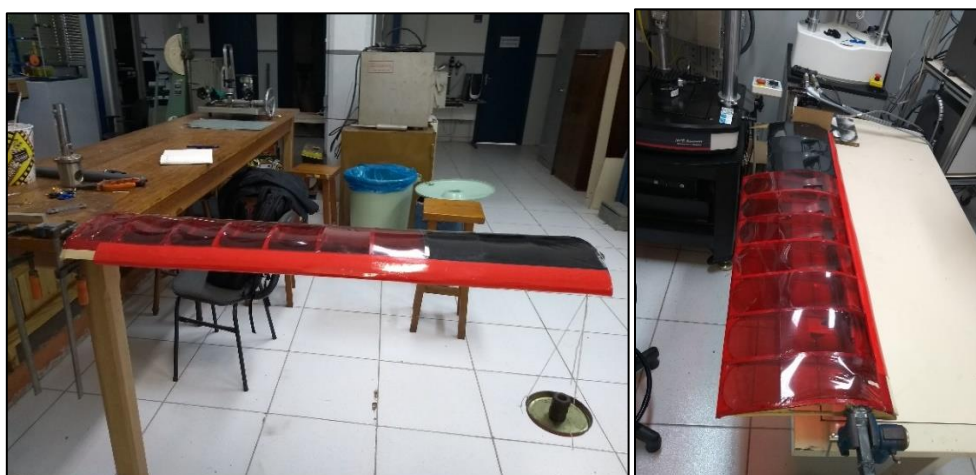
Figura 7 - Ensaios de Flexão (esquerda) e Torção (direita) realizados em laboratório.
